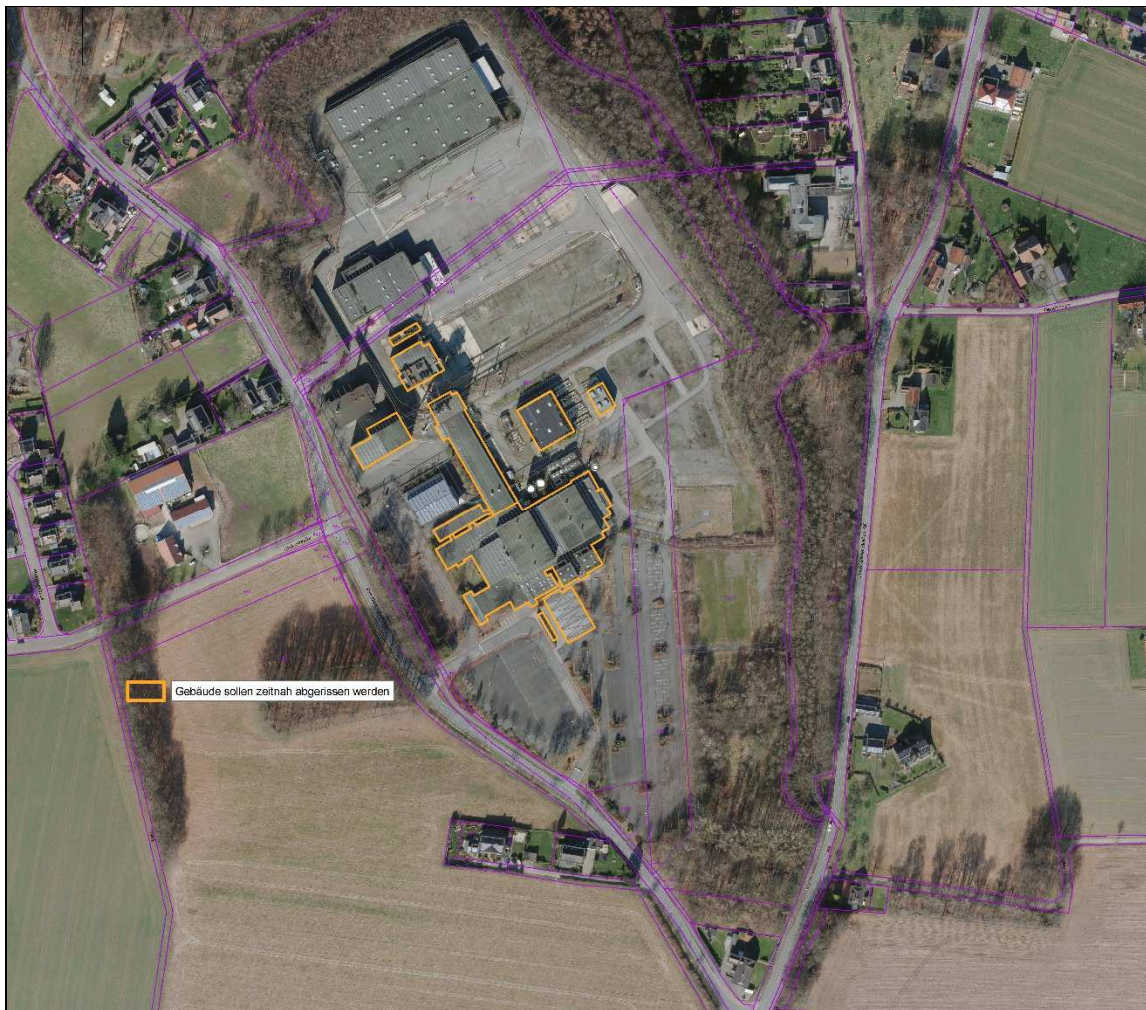
Abbildung 2: Nordschacht mit Kennzeichnung der geplanten Gebäudeabrisse
